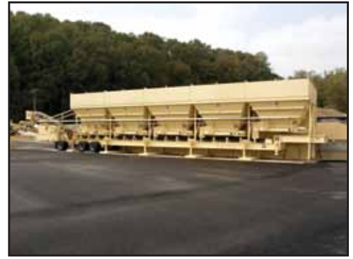
Una carga contiene la unidad de alimentación en frío completa.
