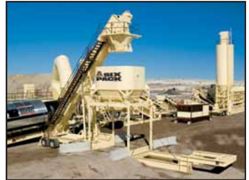
La SEB combina diferentes operaciones en una sola unidad: transporte, filtrado, compensación, almacenamiento, pesaje y carga de camiones.
