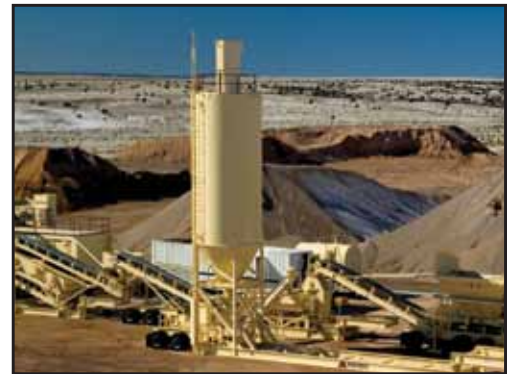
El silo portátil de aditivos almacena cal, rellenos minerales o finos de la cámara de filtros hasta que se necesiten en una mezcla.
