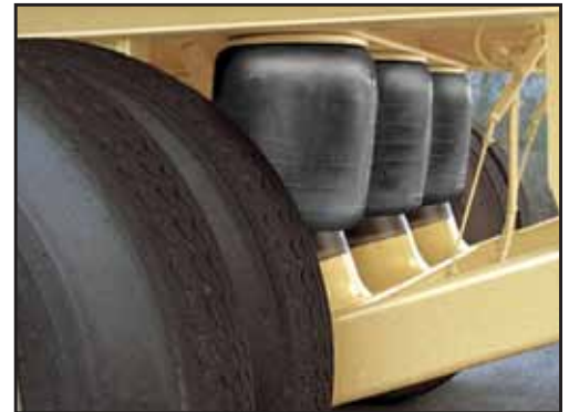
Las bolsas de aire se ajustan automáticamente según las alturas libres de puentes y sobre el suelo.
