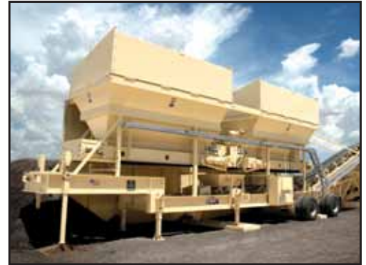
El sistema opcional de dos tolvas de RAP permite aumentar el uso de RAP con resultados de calidad.
