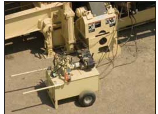
El tambor se eleva a la posición de trabajo por medio de una unidad hidráulica suministrada.
