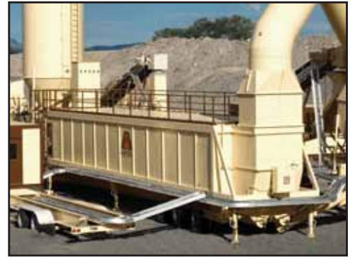
El diseño con perfil bajo de la cámara de filtros facilita el traslado.
