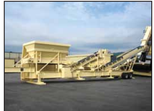
El sistema de RAP es compacto y portátil, y se reubica fácilmente cuando llega el momento de trasladarlo.
