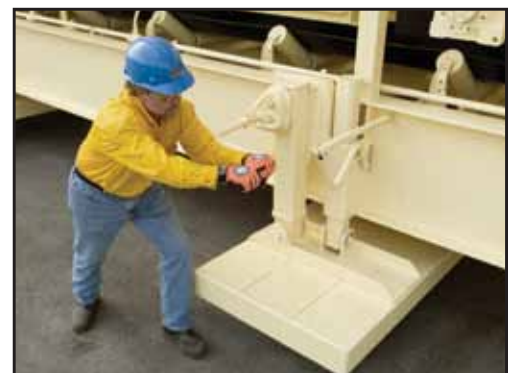
Los ingenieros de Astec han diseñado los cimientos de las plantas de asfalto en caliente Six Pack para facilitar su emplazamiento.
