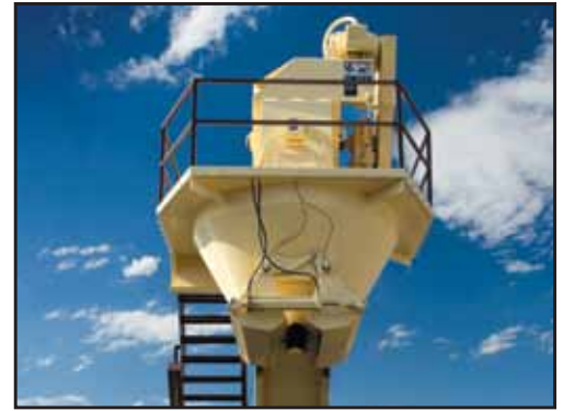
Las escalerillas, peldaños, plataformas y barandillas se despachan instalados en su lugar.
